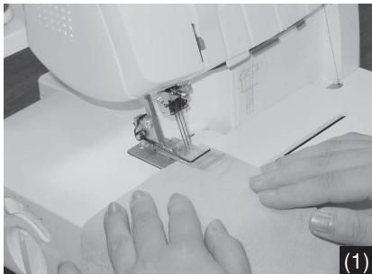
(1) Levante el prensatelas y, a continuación, coloque el tejido en la posición de entrada de la aguja.
