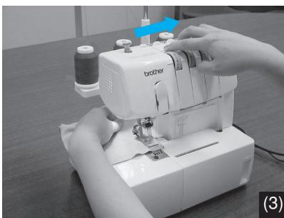
(3) Mientras sujetá firmemente el tejido con la mano, presione hacia la derecha el botón de liberación del hilo de la aguja que está utilizando actualmente para abrir el disco de tensión del hilo.
